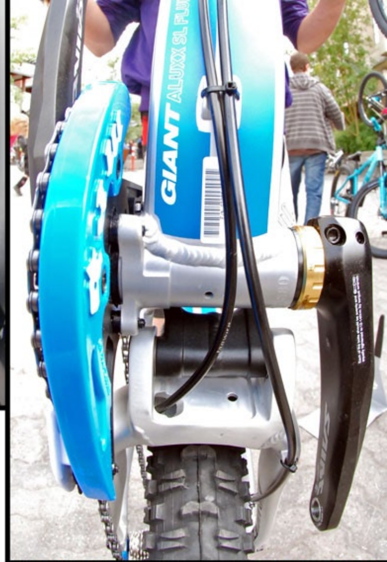
Zdjęcie u góry: „Y-Bone” oraz otwarte profile zawieszenia. Zdjęcie po prawej: dość niefortunne poprowadzenie przewodów.
