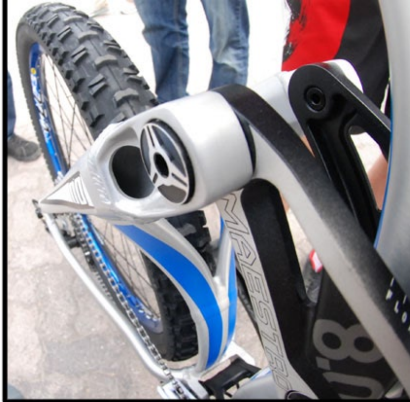
Zdjęcie u góry: „Y-Bone” oraz otwarte profile zawieszenia. Zdjęcie po prawej: dość niefortunne poprowadzenie przewodów.
